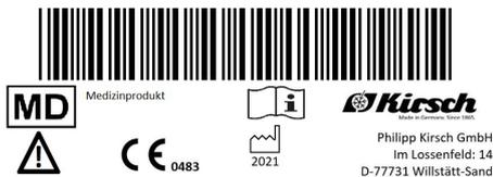
Abb. 9: Beispiel für ein Typenschild (BL 176 PRO-ACTIVE)
